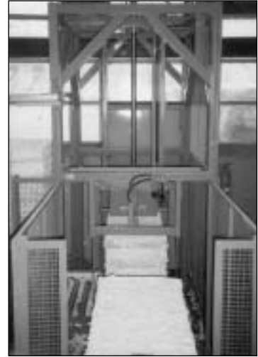
4 Hydraulisches Stapelgerät mit seitlichen Zangenplatten übernimmt den Ballen, hebt diesen hoch und stapelt auf den daruntergefahrenen, im Minutentakt.
