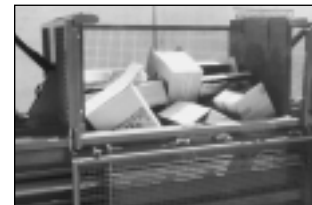
Große Einfüllöffnung mit hydraulischen Deckeln und Sicherheitsgitter
