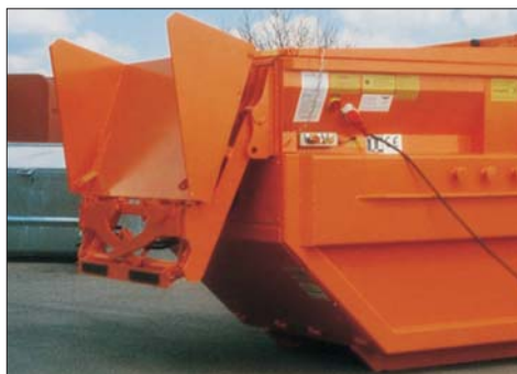
BERINGER reducer x4/6 cbm ■ mit Sonder-Hub-Kipp-Vorrichtung für 1000 l Gefäße und klappbaren Aufnahmearmen in Transportstellung
