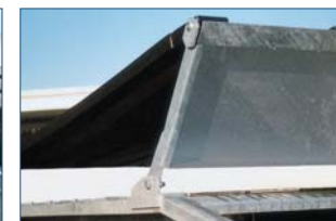
Zusätzliche Öffnungsvergrößerung über Scharnierblech - zur besseren Entleerung
