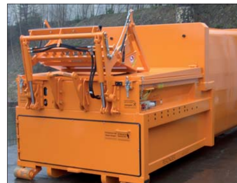
BERINGER reducer x6-520 ■ mit Hub-Kipp-Vorrichtung in Transportstellung
