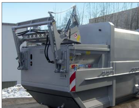
BERINGER reducer x4/10 cbm ■ mit Hub-Kipp-Vorrichtung
