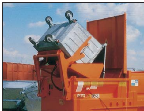
BERINGER reducer x4/6 cbm ■ mit Sonder-Hub-Kipp-Vorrichtung in Kippstellung
