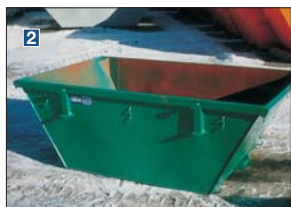
3 Hochentleerung über Seilösen
