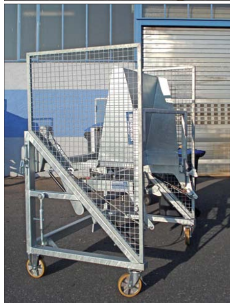
■ Hub-Kipp-Vorrichtung, fahrbar, mit Aufnahme für Zapfen und Kamm; für Gefäße von 80 bis 1100 l
