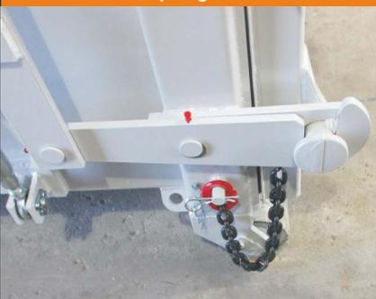
Zentralverschluss mit Betätigung über die Ratsche der Türverriegelung
