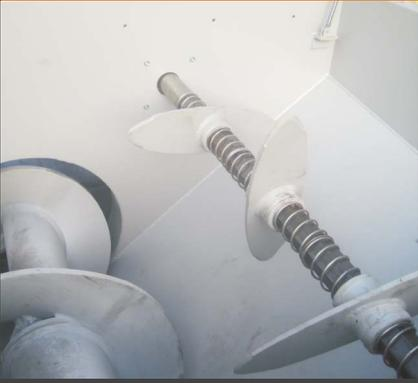
Verstärkte Schneckenwendel und 2x Brecherwellen, ausgelegt für die Holzerkleinerung
